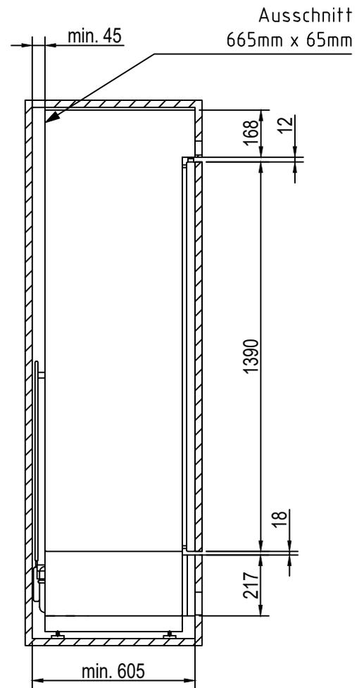
Wenn der MED/ LABO/ LABEX eingebaut wird und es notwendig ist das Bedienteil auf die Möbelfront zu Montieren, entfällt die Funktion vom Schloss. Um das Loch in dem Bedienteil zu Schließen wird ein Blindstopfen eingesetzt. (bestellen Firma Kirsch)
