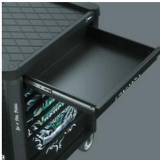
Die Schubladen sind mit kugelgelagerten Teleskop-Schienen ausgestattet und können zu 100 % herausgezogen werden. Der Selbsteinzug und die gegenseitige Verriegelung der Schubladen verhindern ungewolltes Öffnen und minimales Kippisiko des Werkstattwagens. Das durchdachte Schubladendesign ermöglicht die optimale Nutzung des Innenraums. Die schmutzunempfindliche Schubladen-Beschichtung macht die Reinigung einfach.
