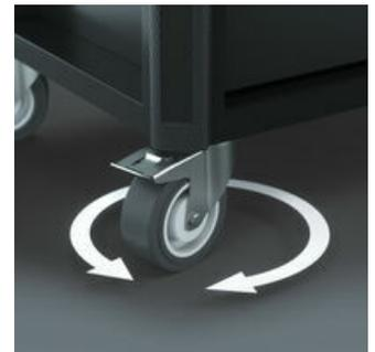
Die 2 Lenkrollen sind mit Doppelstopp ausgestattet: Die gebremste Rolle verhindert zuverlässig das Wegrollen, das gebremste Schwenklager verhindert das ungewollte Drehen der Lenkrollen, z. B. auf schrägen Flächen. Die öl- und säurebeständigen Elastikrollen sorgen für einen ruhigen Lauf. Ein Schutzring vermeidet das Eindringen von Schmutz und Fäden.
