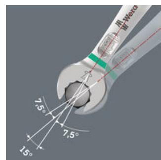
Durch die um 7,5° geschwenkte Maulseite, Doppelsechskantgeometrie und eine angepasste Anwendungsweise (Ansetzen – Schrauben – Drehen – erneut Ansetzen – Schrauben – Drehen usw.) können auch Schraubsituationen gelöst werden, die weniger als 30° Schwenkwinkel zulassen.
