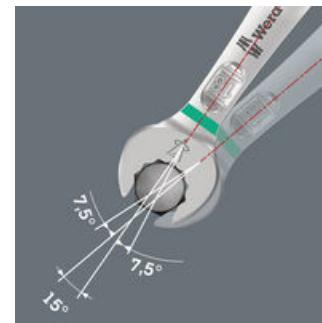
Durch die um 7,5° geschwenkte Maulseite, Doppelsechskantgeometrie und eine angepasste Anwendungsweise (Ansetzen – Schrauben – Drehen – erneut Ansetzen – Schrauben – Drehen usw.) können auch Schraubensituationen gelöst werden, die weniger als 30° Schwenkwinkel zulassen.
