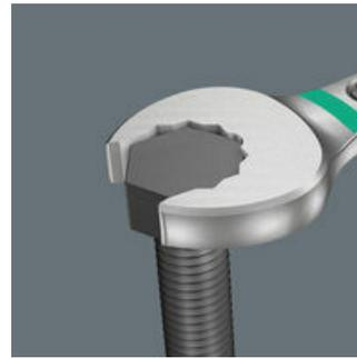
Die Doppelsechskantgeometrie des Mauls des Doppelmaulschlüssels Joker 6005 sichert die formschlüssige Verbindung mit dem Schraubenkopf oder der Mutter und verringert die Abrutschgefahr.
