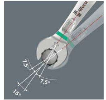
Durch die um 7,5° geschwenkte Maulseiten, die Doppelsechskantgeometrie und eine angepasste Anwendungsweise (Ansetzen - Schrauben - Drehen - erneut Ansetzen - Schrauben - Drehen usw.) können auch Schraubsituationen gelöst werden, die weniger als 30° Schwenkwinkel zulassen.
