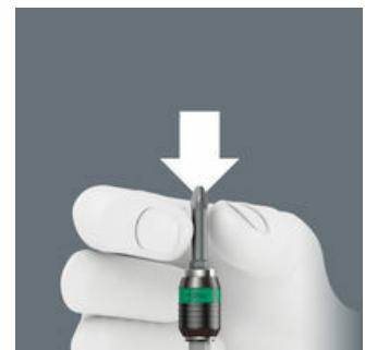
Ohne Betätigung der Hülse kann der Bit in die Aufnahme geschoben werden. Sobald der Bit in der Schraube angesetzt wird, wird die Verriegelung automatisch aktiviert. Der Bit sitzt sicher und wackelfrei.
