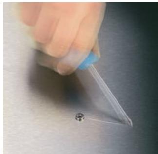
Immer wieder passiert es, dass man beim Verschrauben aus der Schraube rutscht. Manchmal werden dabei wertvolle Oberflächen beschädigt oder man verletzt sich sogar. Die Spitze von Wera Lasertip-Schraubendrehern wird mit Laserstrahlen mikroskopisch fein aufgeraut. Diese rauhe Oberfläche „beißt“ sich förmlich im Schraubenkopf fest. Das unbeabsichtigte Herausrutschen kann damit vermieden werden.
