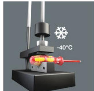
Auch bei extremen Einsatzbedingungen ist durch die geprüfte Kaltschlagfestigkeit bei  $-40^{\circ}\text{C}$  die Sicherheit gewährleistet.
