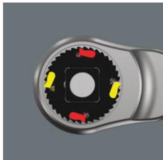
Durch die Doppelklinkenkonstruktion wird aus 38 robusten Zähnen eine 76er Feinzahn-Teilung erreicht. Diese 76er Teilung führt zu einem sehr geringen Rückholwinkel von 4,7°.
