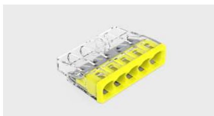
200 x Verbindungsklemmen zum Stecken, 5 x 0,5 ... 2,5 mm 2 „e“ Artikelnr. 2273-205
