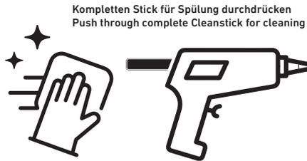
Bei Anwendungsende **IMMER** mit Spülstick reinigen
