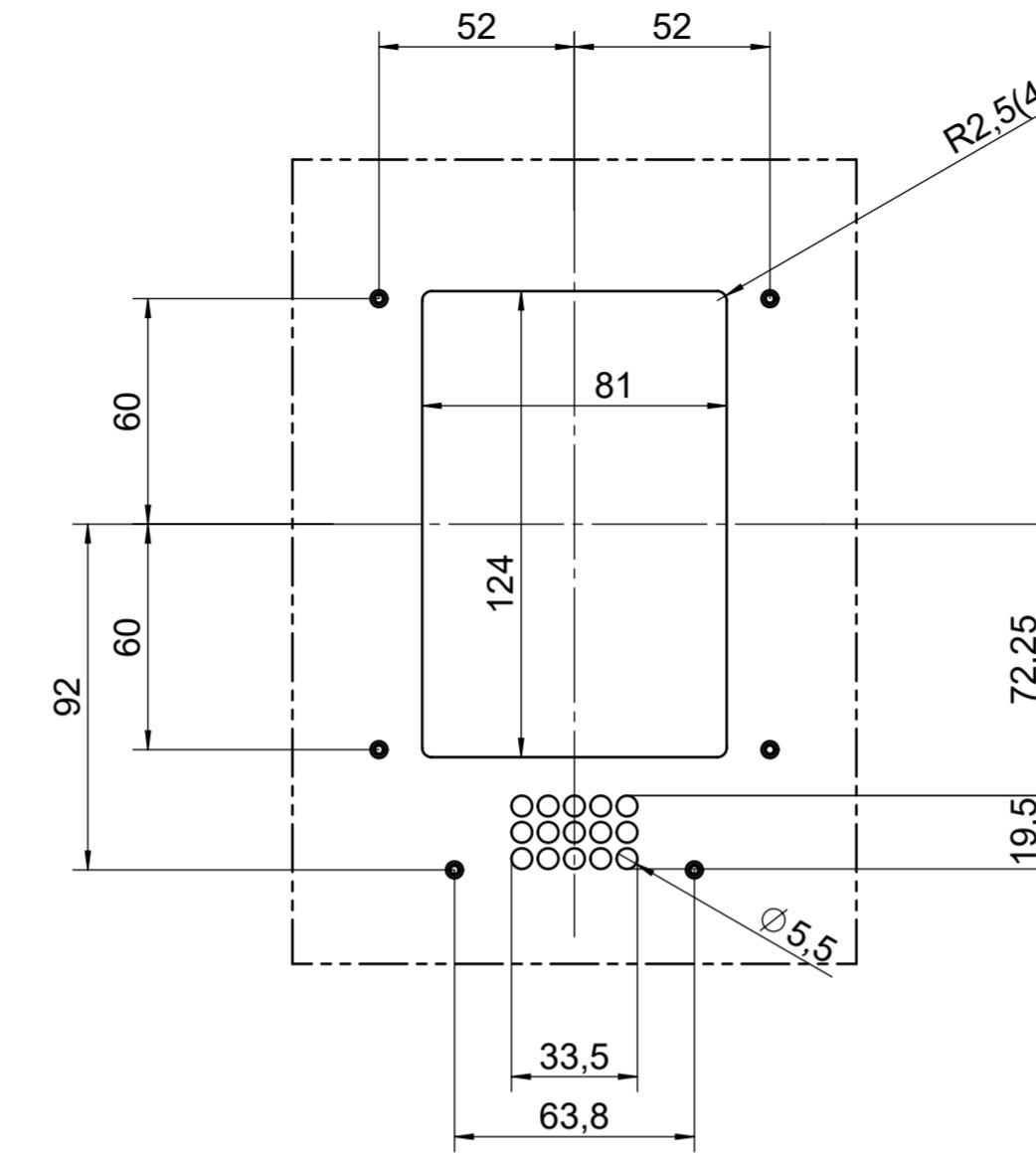
Bauseitiges Fassadenelement mit Auschnitt für Bildschirm, Lautsprecher und Gewindegelenkpositionen
