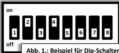
Abb. 1: Beispiel für Dip-Schalter Einstellung Fig. 1: Example for dip-switch configuration
