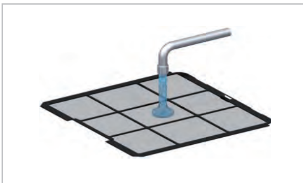
Abb. 52: Reinigung mit lauwarmen Wasser
