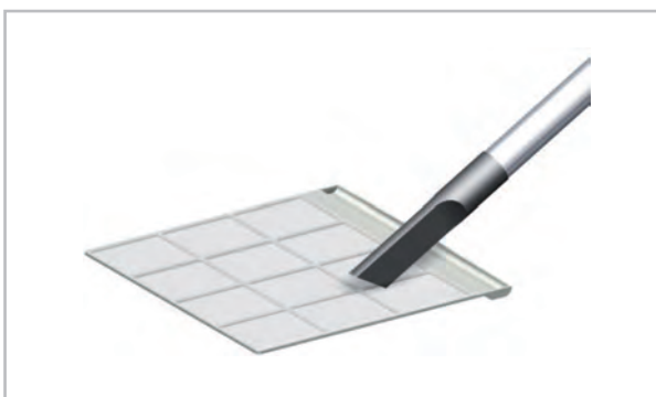
Abb. 51: Reinigung mit dem Staubsauger
