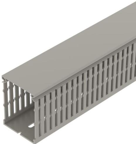
Verdrahtungskanal inkl. Oberteil und Bodenlochung zur waagerechten und senkrechten Verlegung elektrischer Kabel und Leitungen im Schaltschrank. Das Ausbrechen der Stege erfolgt werkzeuglos. Sonderlängen auf Anfrage.
