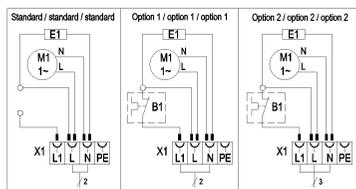
Phase L und L1 müssen die gleiche Phaseanlage haben / Phase L and L1 must have the same phasing
