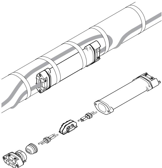
nVent RAYCHEM S-150 ist eine Flachprofil-Verbindungs-garnitur in Kaltanschlusstechnik. Diese universelle Garnitur passt für alle Heizbänder vom Typ nVent RAYCHEM BTV, QTVR, XTV und KTV. Dies ermöglicht eine vereinfachte Produktauswahl und eine reduzierte Lagerhaltung. Die Garnitur kann für Anwendungen im Temperaturbereich von  $-50^{\circ}\text{C}$  bis  $+215^{\circ}\text{C}$  eingesetzt werden und ist für die Verwendung im Ex-Bereich zugelassen.
