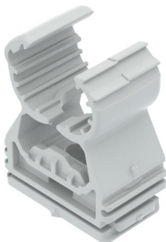
Hochbelastbare Schelle zur Aufnahme von Elektro- und Sanitärrohren aus Kunststoff und Metall sowie Elektroinstallationsrohr Quick-Pipe. Universelle Befestigungsmöglichkeiten an Wand, Decke und Stahlkonstruktionen im Innen- und Außenbereich. Flexibler Spannungsbereich von mehreren Millimetern. Werkzeuglose Rohrmontage. Aneinander reihbar bis Ø 28 mm, auch mit OBO Quick- oder starQuick-Schelle. Für variable Abstände und Schellenanzahl montierbar auf Profilschiene.
