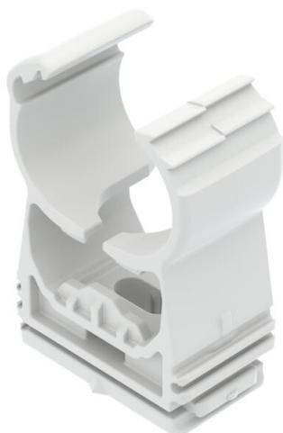
Hochbelastbare Schelle zur Aufnahme von Elektro- und Sanitärrohren aus Kunststoff und Metall sowie Elektroinstallationsrohr Quick-Pipe. Universelle Befestigungsmöglichkeiten an Wand, Decke und Stahlkonstruktionen im Innen- und Außenbereich. Flexibler Spannungsbereich von mehreren Millimetern. Werkzeuglose Rohrmontage. Aneinander reihbar bis Ø 32 mm, auch mit OBO Quick- oder Multi-Quick-Schelle. Für variable Abstände und Schellenanzahl montierbar auf Profilschiene.
