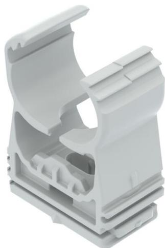
Hochbelastbare Schelle zur Aufnahme von Elektro- und Sanitärrohren aus Kunststoff und Metall sowie Elektroinstallationsrohr Quick-Pipe. Universelle Befestigungsmöglichkeiten an Wand, Decke und Stahlkonstruktionen im Innen- und Außenbereich. Flexibler Spannungsbereich von mehreren Millimetern. Werkzeuglose Rohrmontage. Aneinander reihbar bis Ø 32 mm, auch mit OBO Quick- oder Multi-Quick-Schelle. Für variable Abstände und Schellenanzahl montierbar auf Profilschiene.
