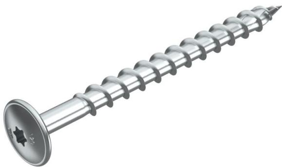
Selbstbohrende Holzschraube zur brandsicheren Befestigung von Kabelanlagen für den Funktionserhalt nach DIN 4102 Teil 12 an tragenden Holzbauteilen. Die Tellerkopfform ermöglicht den Einbau ohne zusätzliche Unterlegscheibe.
