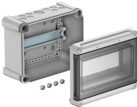
Kleinverteiler zur Aufputz-Montage, für die Strom-Unterverteilung im Innen- und geschützten Außenbereich, gemäß IEC 439-3. Mit vormontierter 35-mm-Hutprofileschiene. Schutzart IP66 und Schutzgrad IK07. Transparenter Deckel zum Schrauben, mit Ausschnitt.
