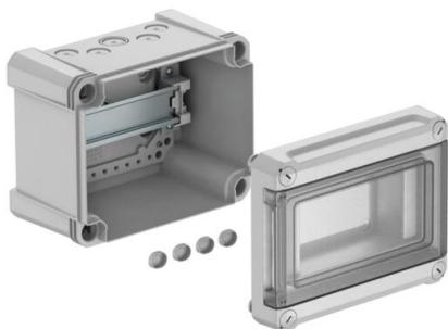
Kleinverteiler mit Klemmleiste zur Aufputz-Montage, für die Strom-Unterverteilung im Innen- und Außenbereich, gemäß IEC 439-3. Mit vormontierter 35-mm-Hutprofilschiene. Schutzart IP66 und Schutzgrad IK08. Transparenter Deckel zum Schrauben, mit Ausschnitt. Inklusive 4 Schraubenabdeckkappen.
