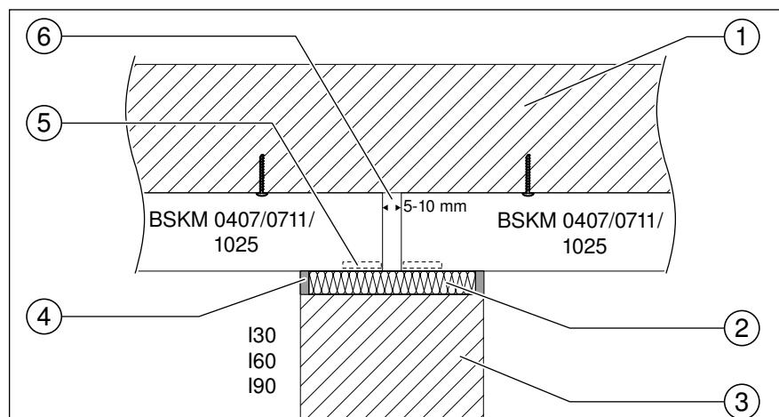
Abb. 28: Wanddurchgang durch Massivwand
