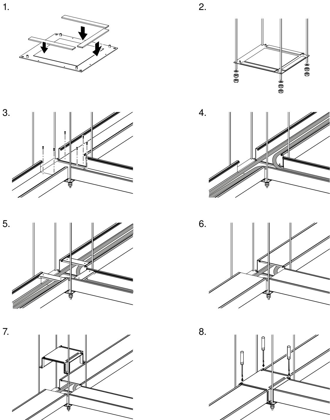
Abb. 57: T-Abzweig montieren
