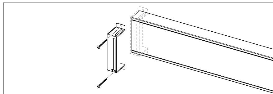
Abb. 40: Endstück montieren
