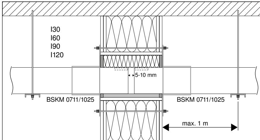
**Abb. 62:** Wanddurchgang durch Trocken-/Leichtbauwand
