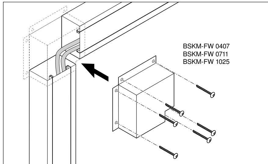
Abb. 30: Flachwinkel montieren
