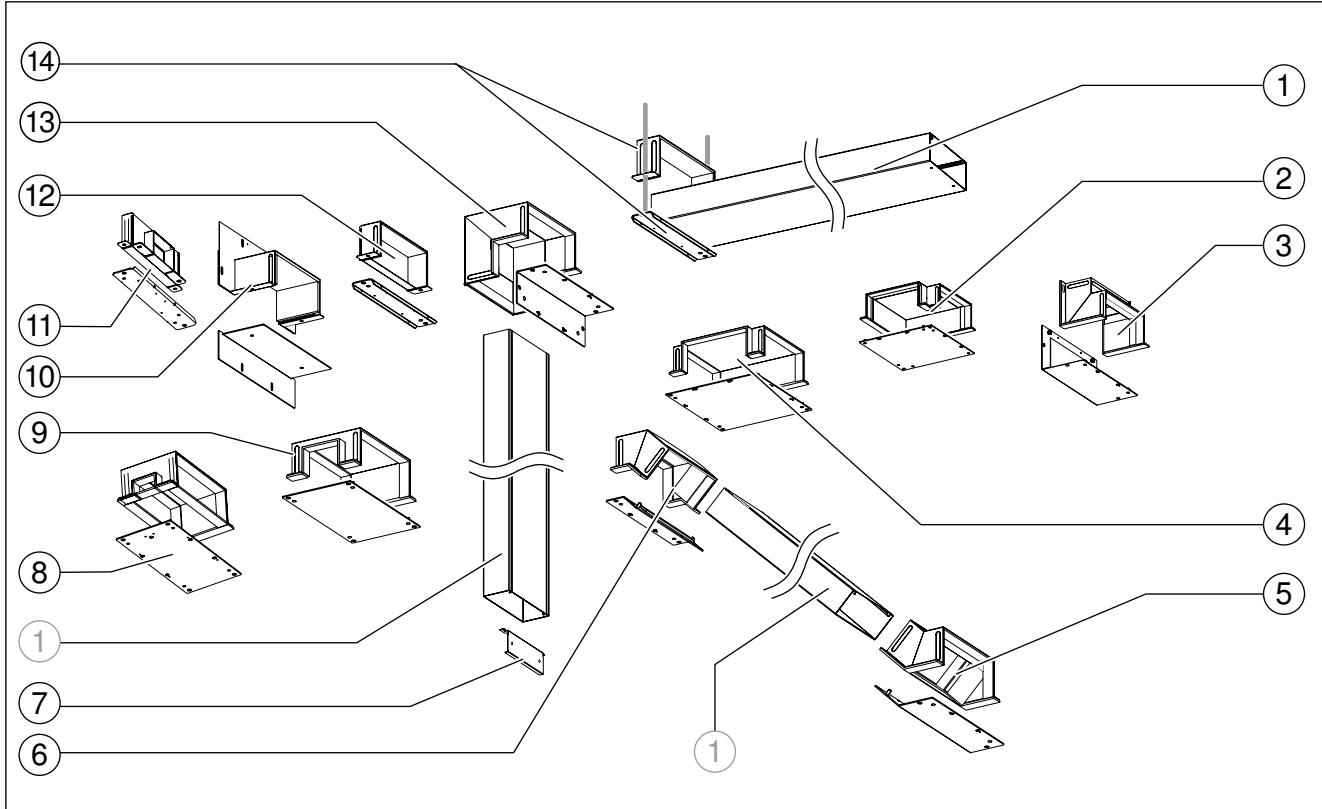
Abb. 7: Systemübersicht, 250 mm Kanalbreite, Montage auf Tragsystem
