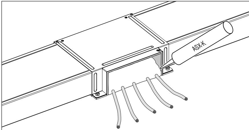
**Abb. 67:** Mehrfach-Kabelausgang in T-Abzweig
