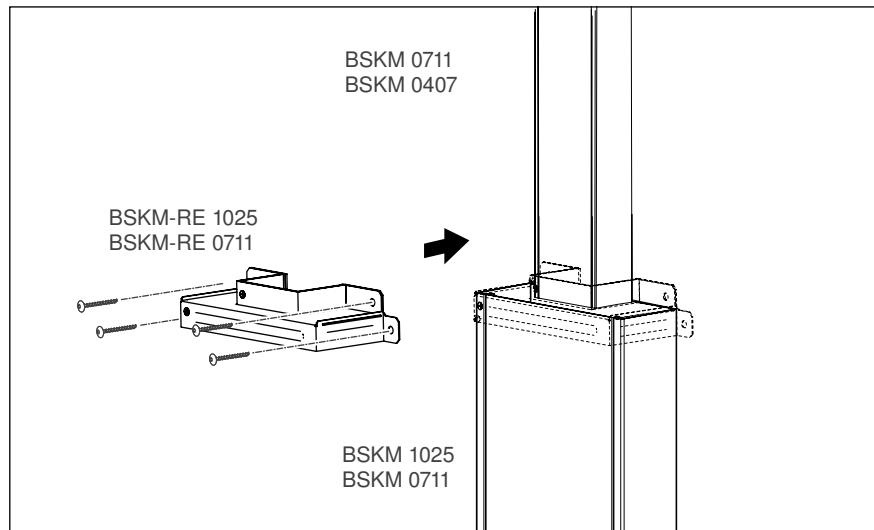
Abb. 38: Reduzierstück montieren
