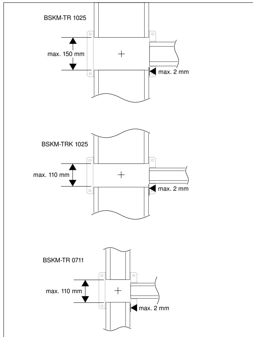
Abb. 37: Montageabstände T-Reduzierabzweig
