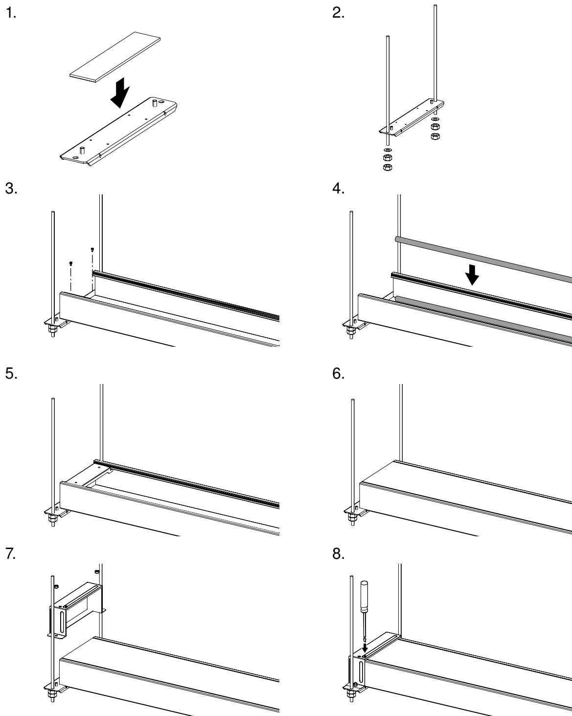
Abb. 64: Endstück montieren
