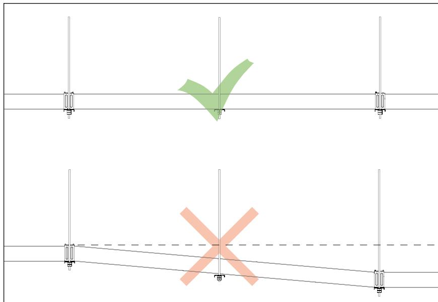
**Abb. 42:** Auf waagerechte Streckenführung achten
