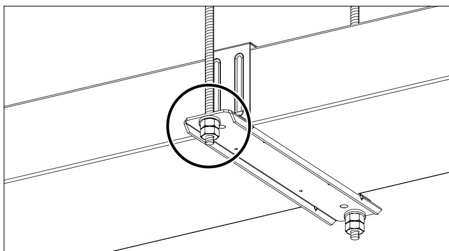
Abb. 41: Auflager durch Mutter und Kontermutter sichern
