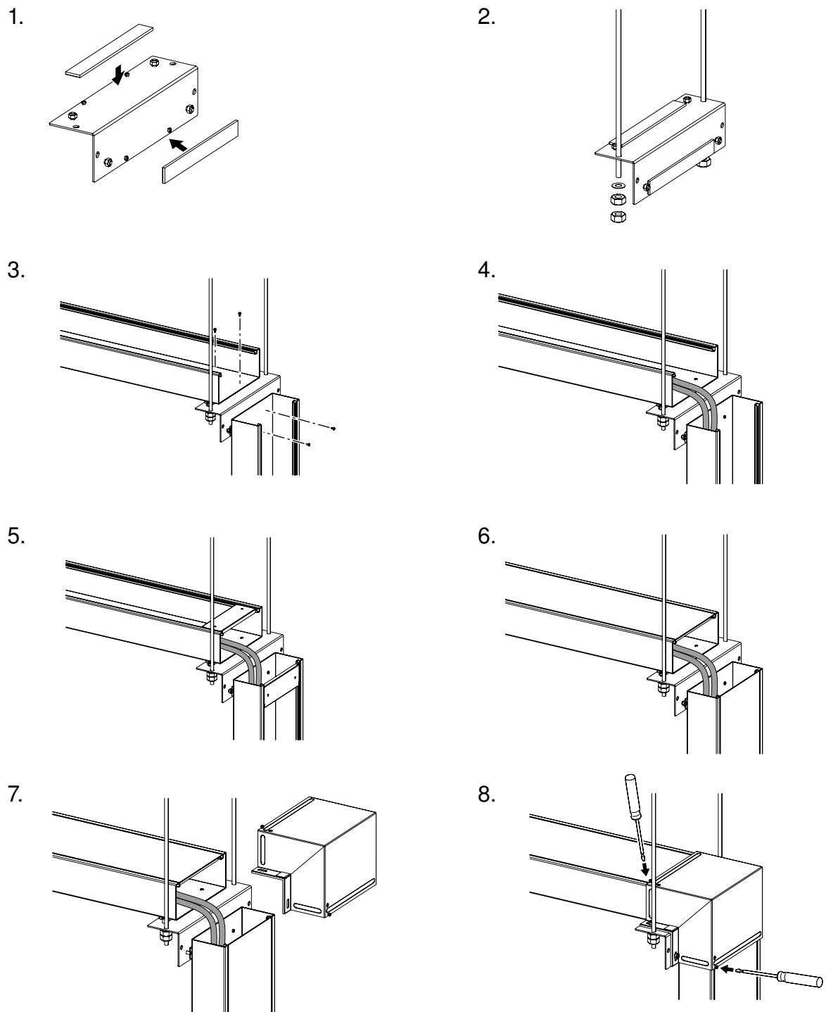
Abb. 53: Außeneck montieren
