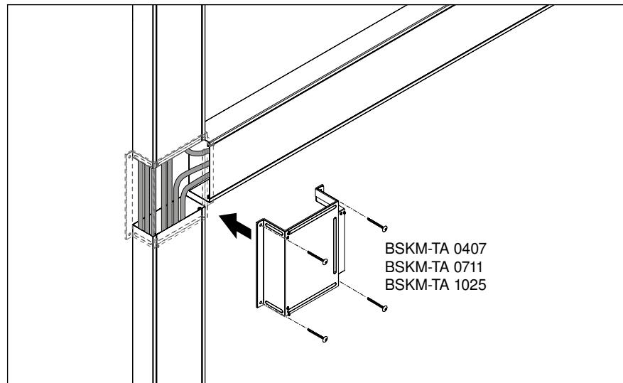
Abb. 34: T-Abzweig montieren
