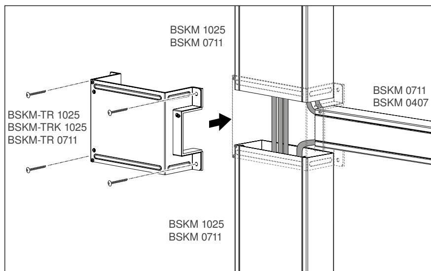
Abb. 36: T-Reduzierabzweig montieren
