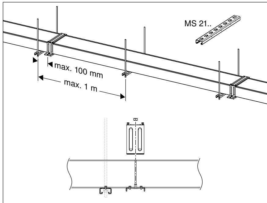
Abb. 46: Streckenführung mit Profilschiene, hier z. B. MS 21..
