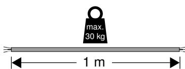
Die maximale zulässige Gesamtlast beträgt 30 kg pro laufendem Kanal meter. Sie darf nicht überschritten werden, da sonst die Trag- und Funktionsfähigkeit nicht mehr gegeben ist.
