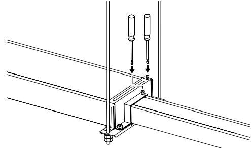
Abb. 59: Reduzierstück montieren
