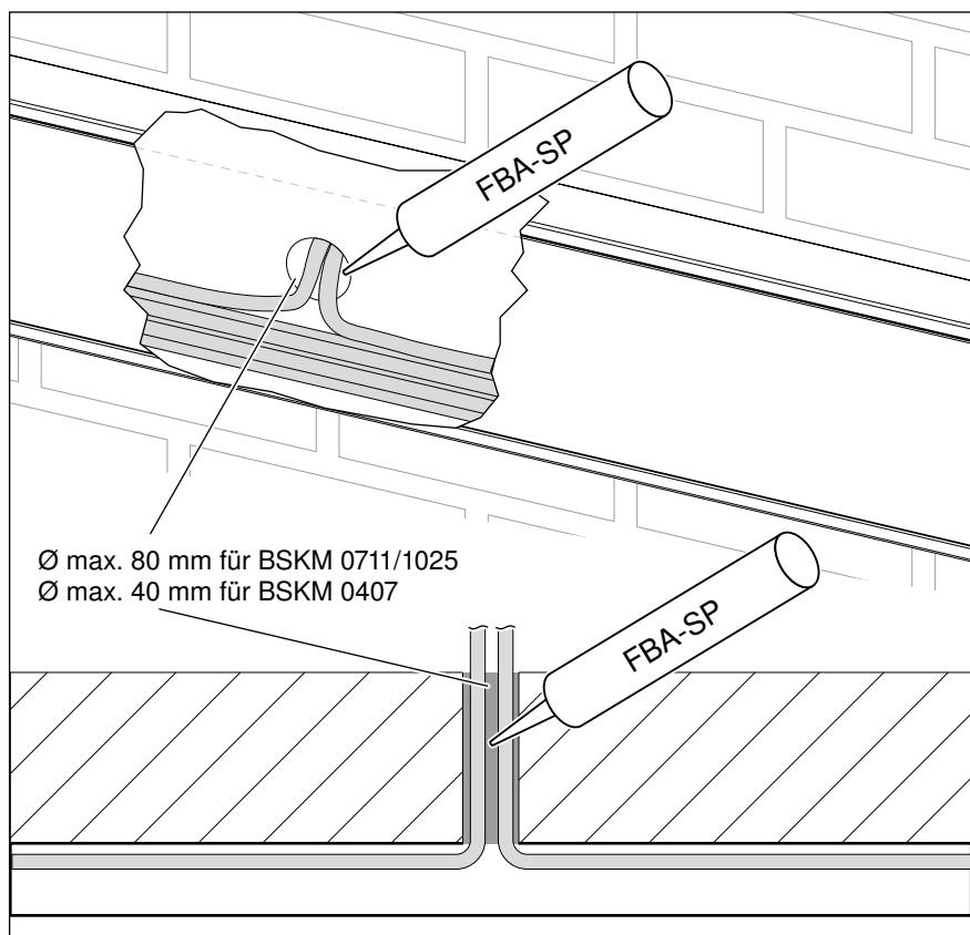
Abb. 68: Rückseitiger Kabelausgang
