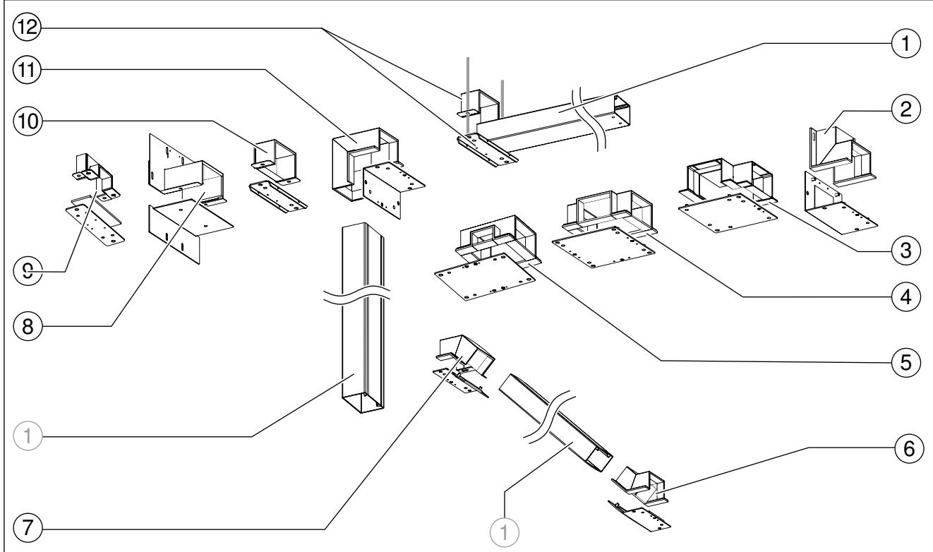
Abb. 8: Systemübersicht, 110 mm Kanalbreite, Montage auf Tragsystem
