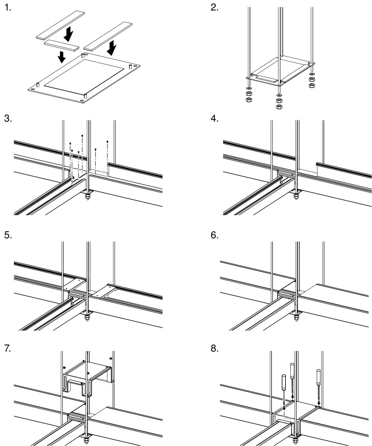
Abb. 58: T-Reduzierabzweig montieren
