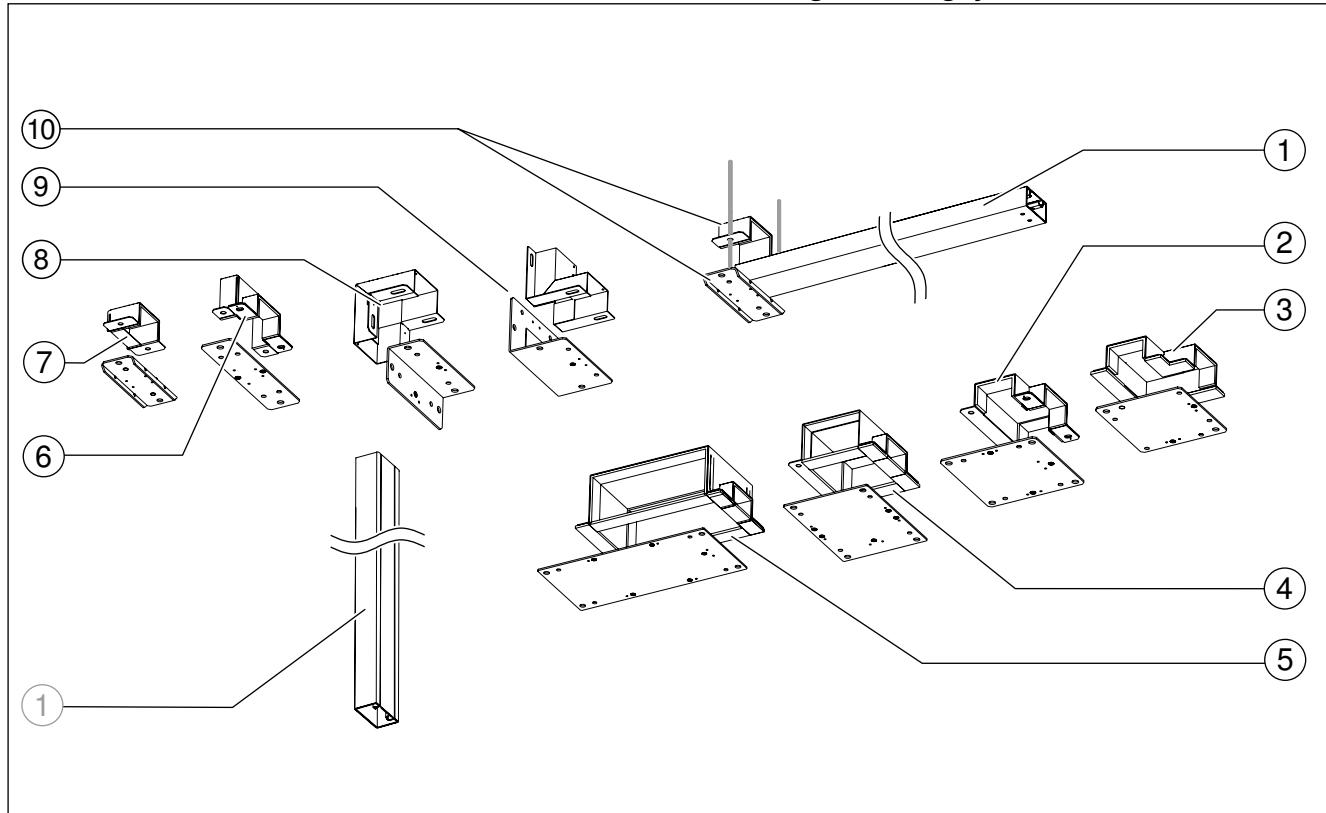
**Abb. 9:** Systemübersicht, 70 mm Kanalbreite, Montage auf Tragsystem
