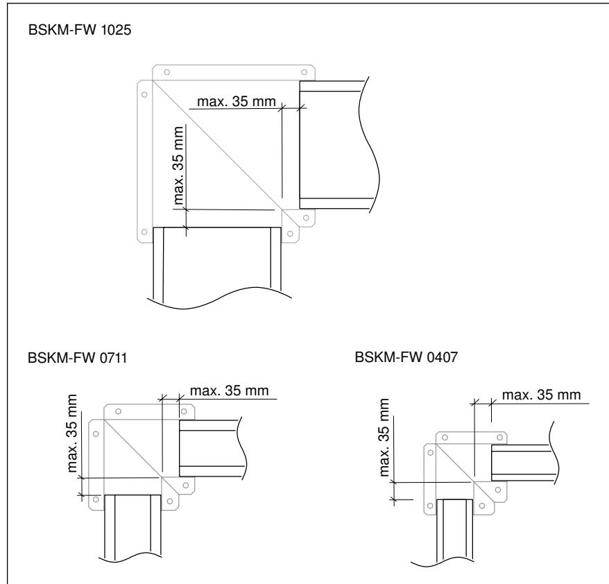
Abb. 31: Montageabstände Flachwinkel
