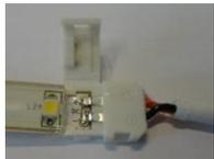
Einfacher, lötfreier Anschluss: die Anschlussstelle der Flexible LED vorsichtig unter die Kontakte des Verbinders schieben, danach die Zugentlastung verschließen.
