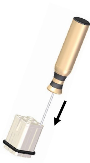
Feder mit Schraubendreher öffnen Open the spring with a screwdriver
