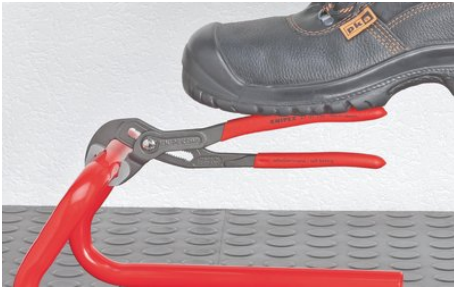
Gegen die Drehrichtung versetzte Zähne bewirken einen Selbstklemmeffekt und verhindern das Abrutschen am Werkstück.
