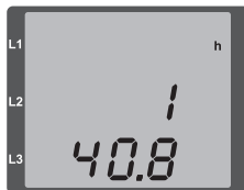
Abb. Messwertanzeige Betriebsstundenzähler
