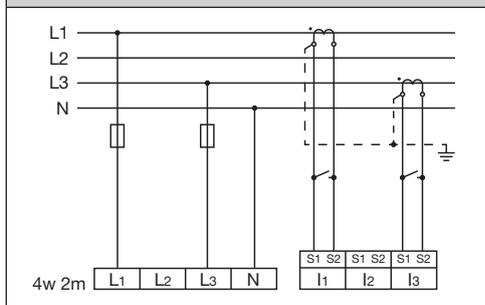
Messung über 2 Spannungswandler in einem Dreiphasen-4-Leiternetz mit unsymmetrischer Belastung.
