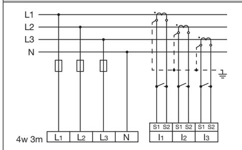
Messung über 3 Spannungswandler in einem Dreiphasen-4-Leiternetz mit unsymmetrischer Belastung.
