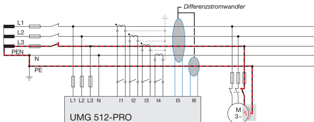
Abb. Beispiel UMG 512-PRO mit Differenzstromüberwachung über die Messeingänge I5/I6.
