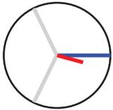
Spannung und Strom haben nur eine geringe Abweichung in der Phasenlage.
