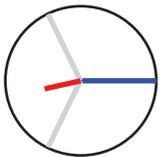
Spannung und Strom haben eine Abweichung von etwa 180° in der Phasenlage.
