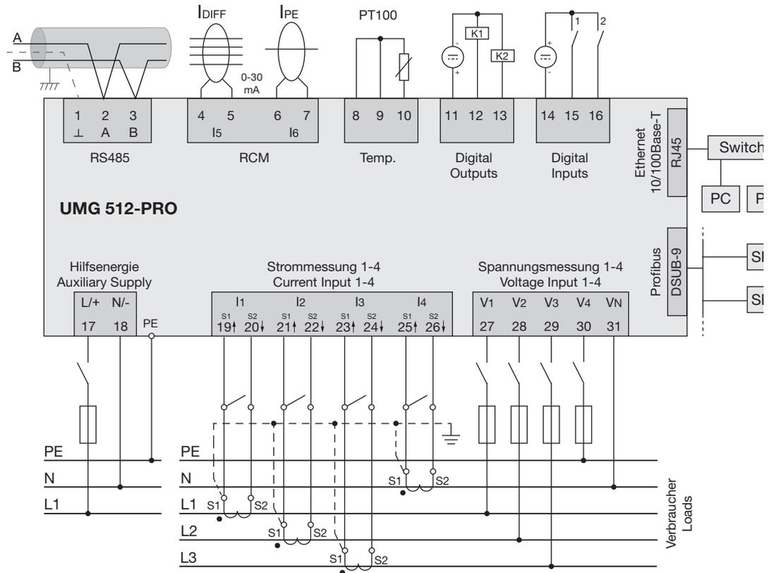
Abb. Schemazeichnung Anschlussbeispiel für das UMG 512-PRO
