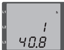
Abb. Messwertanzeige Betriebsstundenzähler Das UMG 96RM-E zeigt im Betriebsstundenzähler die Zahl 140,8h an. Das entspricht 140 Stunden und 80 Industrieminuten. 100 Industrieminuten entsprechen 60 Minuten. In diesem Beispiel entsprechen danach die 80 Industrieminuten 48 Minuten.
