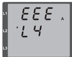
Abb.: Anzeige Messbereichsüberschreitung im Strompfad I4
