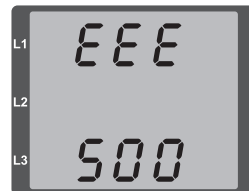
Abb. Warnmeldung mit Nummer 500 (Netzfrequenz)
