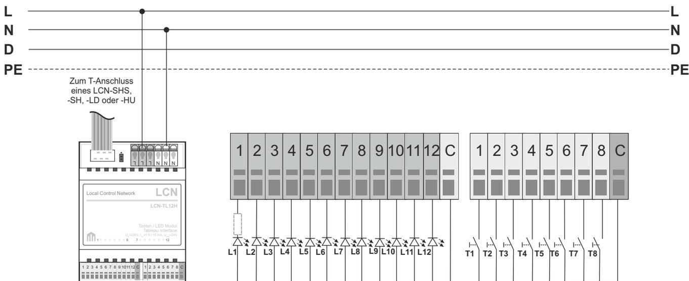
Die Anschlussleitungen für die Taster und LEDs führen N-Potential!
