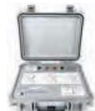
**IMP57 – Adapter** für Impedanzmessung bis 80 kA Kurzschlussstrom
