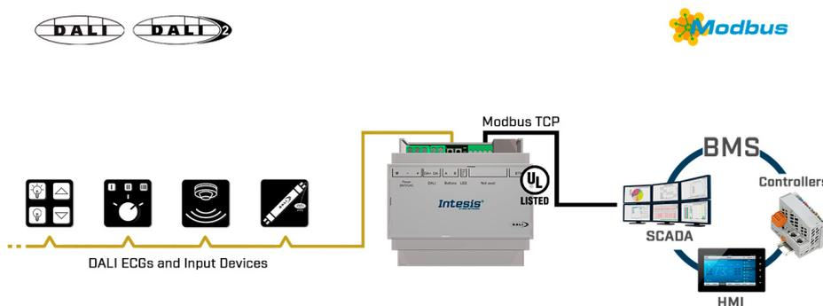
Dieses bidirektionale Gateway bietet dank seiner einzigartigen Onboard-Funktionen eine unkomplizierte und schnelle Integration. Dank seiner Unterstützung sowohl für Modbus RTU als auch für TCP, mit der Möglichkeit, gleichzeitig zusammenzuarbeiten, ist eine nahtlose Integration mit jedem Modbus BMS oder Controller gewährleistet.
