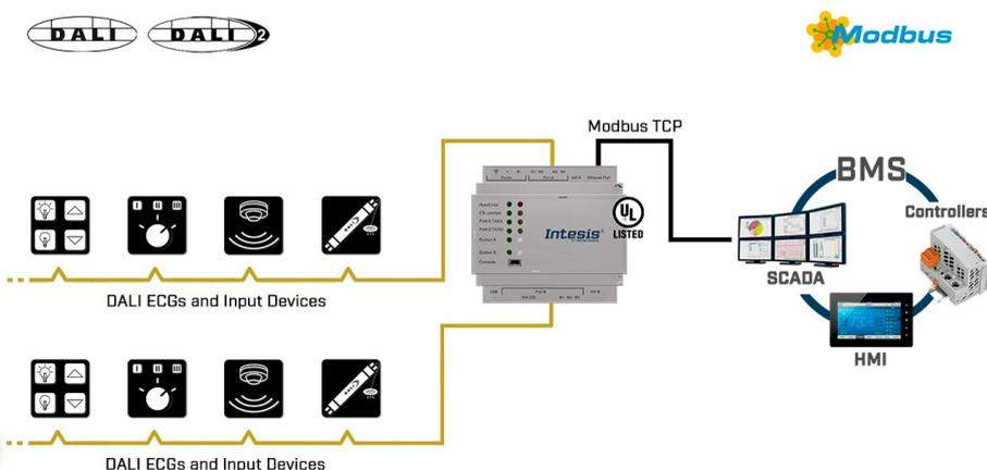
Dieses bidirektionale Gateway bietet dank seiner einzigartigen Onboard-Funktionen eine unkomplizierte und schnelle Integration. Dank seiner Unterstützung sowohl für Modbus RTU als auch für TCP, mit der Möglichkeit, gleichzeitig zusammenzuarbeiten, ist eine nahtlose Integration mit jedem Modbus BMS oder Controller gewährleistet.
