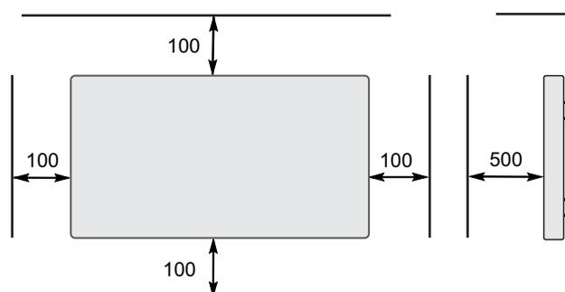
Durante l'installazione dell'apparecchio da riscaldamento con presa elettrica e termostato ambiente rispettare rigorosamente l'ambito di protezione a norma VDE 100-701.
