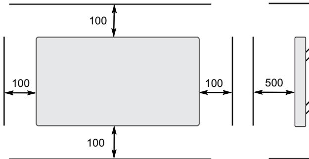
Pour l'installation de l'appareil de chauffage avec une prise de raccordement secteur et un thermostat d'ambiance, respecter impérativement la zone de protection définie par VDE 100-701.
