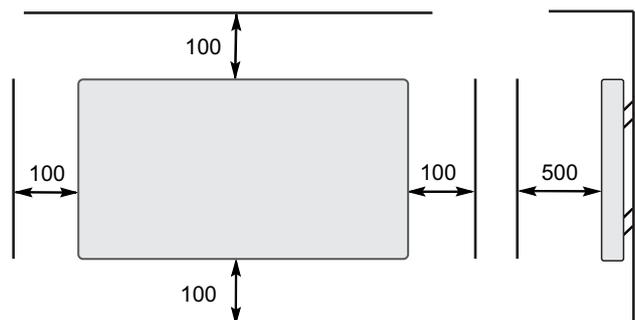
Bei der Installation des Heizgerätes mit Netzanschlussdose und Raumthermostat ist der Schutzbereich nach VDE 100-701 zwingend zu beachten.
