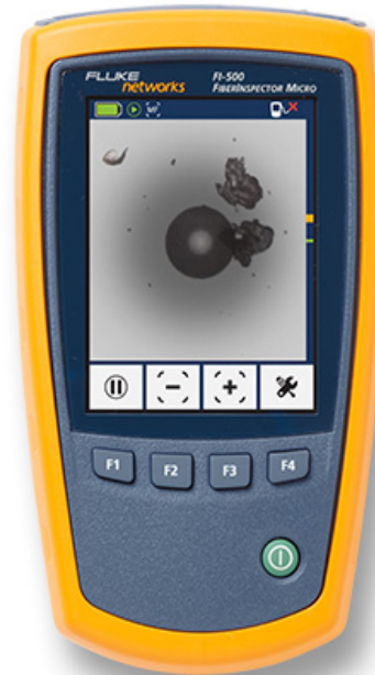
FI-500 zeigt eine verschmutzte Glasfaser-Endfläche an
