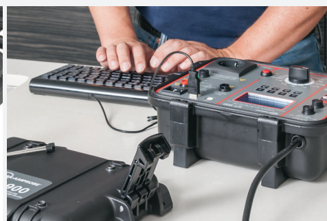
Drei separate USB-Schnittstellen zum gleichzeitigen Anschluss an PC und Eingabegeräten wie USB-Tastatur, USB-Barcodescanner, USB-Speicher oder Bluetooth Geräte mit USB-Dongle (optional)
