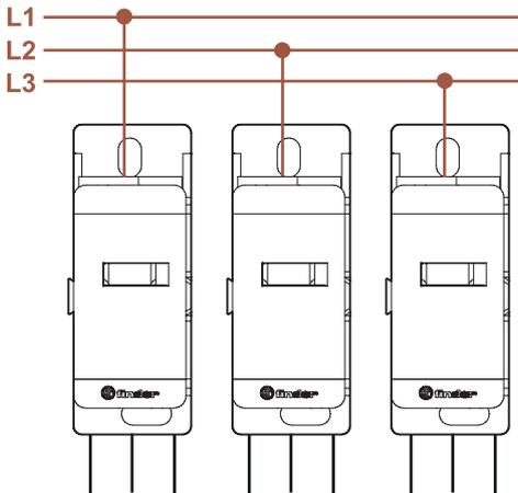
**Mehrpölicher Anschluss, durch Kombination mehrerer Verteilerblöcke.**
