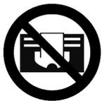
**WARNUNG:** Das Abdecken der Oberfläche verursacht Überhitzungsgefahr! Bereits lokales Abdecken der Front, z.B. mit einem Handtuch, kann zum Überhitzen und zur Beschädigung des Heizelements führen.
