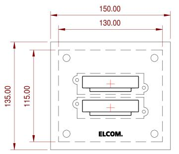
KVM-2/1 ESTA Unterputz-Klingeltableau Glatte Platten-Ausführung in Edelstahl Edelstahlfrontplatte matt gebürstet 2mm Stärke und umlaufende Dichtung befestigt mit Spezialschrauben aus Edelstahl. Hinterbautaster mit integriertem flächenbündigem Namenschild, taktiele Rückmeldung durch Microtasterschaltkontakt sowie integrierter LED Beleuchtung (weiss) Namenschildwechsel per Spezialschlüssel von vorn FPL 150\*135\*2mm UPK 130\*115\*55mm
