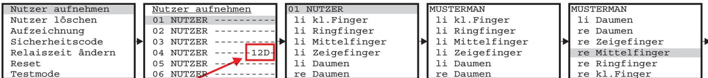
Bereits gespeicherte Finger sowie die Relais Zuordnung wird angezeigt.
