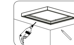
Hauptschalter für den betroffenen Bereich ausschalten. Stecken Sie den Rahmen vollständig zusammen, um bei der Anfertigung der Bohrlöcher Verformungen vorzubeugen. Halten Sie den Anbaurahmen an den dafür vorgesehenen Platz und zeichnen Sie die Löcher für die Bohrungen an drei Seiten an. Die vierte Seite muss nicht angezeichnet und gebohrt werden, diese wird später aufgesteckt. Fertigen Sie nun die Löcher für den Anbaurahmen an drei Seiten an.
