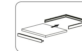
Zum Einlegen des Panels und zur Befestigung des Rahmens, entnehmen Sie eine Seite des zuvor zusammengebauten Rahmens und verschrauben Sie den Rest an der Decke. Schließen Sie das LED-Netzgerät an das Stromnetz an und legen Sie dieses auf das Panel. Schieben Sie das Panel nun in den Rahmen ein und stecken Sie das entnommene Teil des Rahmens wieder auf. Versorgungsnetz freischalten und Funktionstest.
