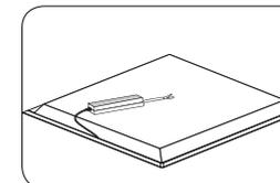
Platzieren Sie das Netzgerat auf der Ruckseite des Panels.
