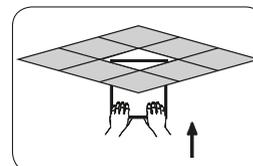
Setzen Sie das LED-Panel in das Deckenraster ein.
