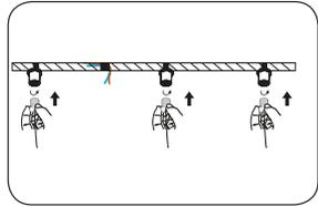
Schrauben Sie das Aufhängekabel an die Deckenbefestigung.
