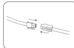
Verbinden Sie das LED-Panel Kabel mit dem LED-Netzgerat.
