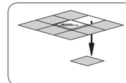
Entfernen Sie ein Deckenpaneel neben dem LED-Panel.
