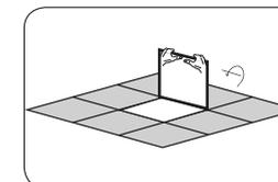
Platzieren Sie das LED-Panel in einer Linie mit dem Deckenraster.
