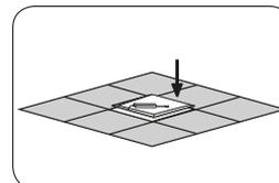
Stellen Sie sicher, dass die Platte gleichmaig innerhalb des T-Bar-Deckengitters sitzt.
