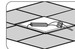
Schlieen Sie den LED-Netzgerat an das Stromnetz an. Ersetzen Sie das Deckenpaneel, um die Installation abzuschlieen.
