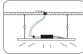
Schließen Sie den LED-Netzgerät an das Stromnetz an.
