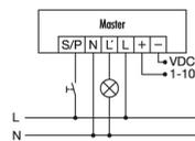
Standardbetrieb mit zusätzlicher Ansteuerung durch Schlieftaster. Bei Bedarf kann das Licht durch den Taster manuell ein- bzw. ausgeschaltet werden.
