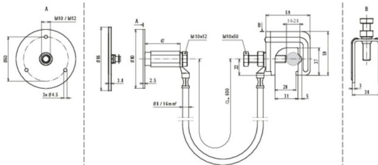
Anschlussgarnitur bestehend aus Verbindungsleitung mit angeschlossener Verbindungsklemme und Erdungsfestpunkt.
