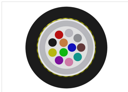
Kabelquerschnitt des 12F MiniXtend CT Kabels
