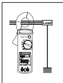
**Nota:** Per ragioni di sicurezza, disinserire i cordoni di misura della pinza prima d'effettuare l'operazione. La misura è ottimale con il conduttore centrale in mezzo alle ganasce
