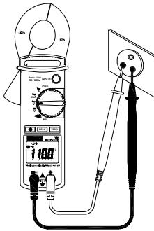
Drehschalter auf **V~** für AC-Spannungen bzw. auf **V=** für DC-Spannungen stellen.
