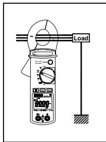
**Nota:** Por medidas de seguridad, desconectar los cables de medida de la pinza antes de efectuar esta operación. La medida es óptima con el conductor centrado en el interior de las mordazas.
