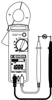
Positionner le commutateur sur Hz pour une mesure de fréquence en tension alternative.
