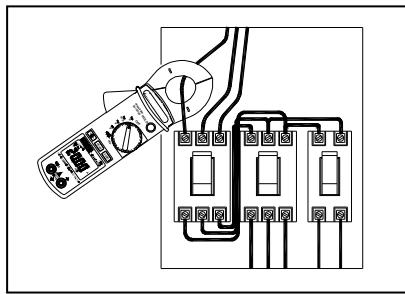
Drehschalter auf A~ stellen Die Zangenbacken durch Druck auf die Öffnungstaste öffnen.
