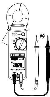
Posizionare il commutatore su Hz per una misura di frequenza in tensione alternata.
