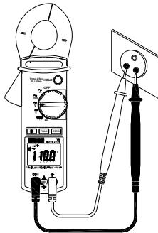
Posizionare il commutatore su V~ per una misura di tensione alternata o su V= per una misura di tensione continua.
