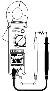
Positionner le commutateur sur  $\Omega$ . Connecter le cordon de test rouge à la borne d'entrée "+" et le noir à la borne d'entrée "COM". Mettre les pointes de touche en contact avec les points à mesurer et lire le résultat sur l'afficheur.
