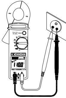
Positionner le commutateur sur V~ pour une mesure de tension alternative ou sur V= pour une mesure de tension continue.
