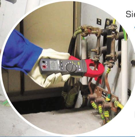
Sie verfügen über eine **10000 Digit-Anzeige mit Hintergrundbeleuchtung**, Anzeigenspeicherung, **Max.-Wert-** und **Differenzwertmessung (Delta)**.
