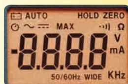
LCD-Display mit 10000 Digit und Hintergrundbeleuchtung
