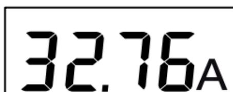
Se la misura supera la capacità di visualizzazione (400 A), lo strumento indica 399.9 (lampeggio).
