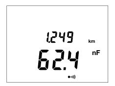
Das Gerät zeigt den Kapazitätswert und die entsprechende Leitungslänge, die anhand der programmierten linearen Kapazität kalkuliert wird.
