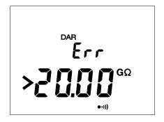
Bei C.A 6532, wenn dieser Fall beim DAR- bzw. PI-Messen auftritt, unterbricht das Gerät die Messung und es erscheint die gegenüber abgebildete Anzeige.
