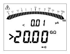
Sollte bei der Isolationsmessung ein Messwert auftreten, der den Messbereich überschreitet (dieser hängt jeweils vom Gerät und der Prüfspannung ab), erfolgt eine Meldung durch das Gerät.
