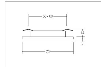
LED-Einbaudownlightset, aluminium, rund. Ausgeführt in kompakter Bauform für werkzeuglose Schnellmontage zum Deckeneinbau. Leuchtenset optimiert zur Installation in Möbeln und Holzwerkstoffen mit 3 x Leuchten mit je 2.000 mm Anschlussleitung, 1 x Verteiler und 1 x Netzgerät für 230 V-Netzspannung, schaltbar, Maße Netzgerät: L 105 x B 49 x H 18 mm.
