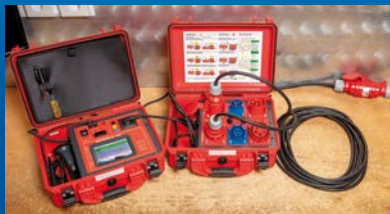
Prüfung einer 5-poligen CEE-Verlängerung
