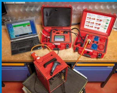
Prüfung eines 3-phasigen Heizlüfters
