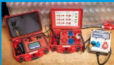
Prüfung einer mobilen Stromverteilung mit RCD
